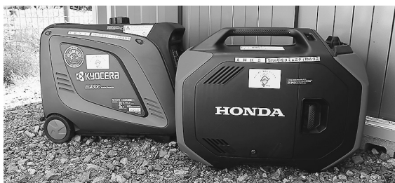
エンジン発電機(1台)、インバータ発電機(1台)
